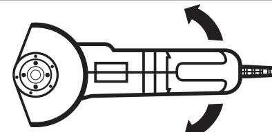
Изделие с раскручивающимся или останавливающимся диском обладает повышенным боковым крутящим моментом. Не выпускайте его из рук при запуске и выключении до полной остановки диска
