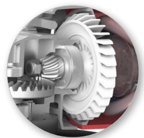
Шариковый подшипник в опоре шпинделя
