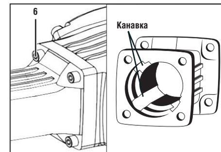
■ отверните гаечным ключом болты **6** крышки цилиндра и снимите крышку, цилиндр и поршень;
