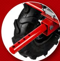
Кронштейн для крепления навесного оборудования (диаметр 30 мм)
