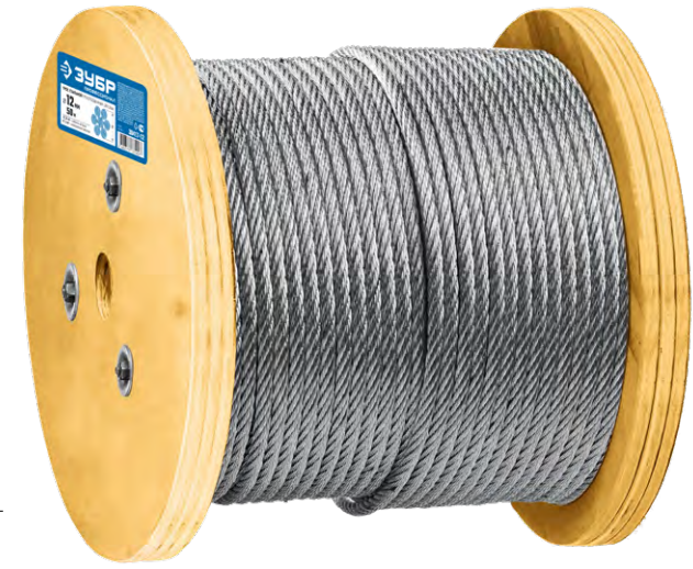
DIN 3066 – усиленная структура 6 x 37 (6 прядей, обвитых вокруг сердечника, по 37 проволок в каждой пряди)
