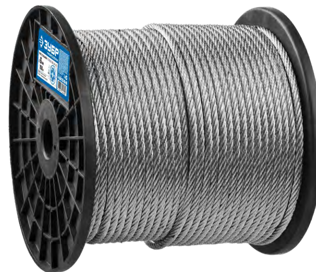
DIN 3055 – структура 6 x 7 (6 прядей, обвитых вокруг сердечника, по 7 проволок в каждой пряди)
