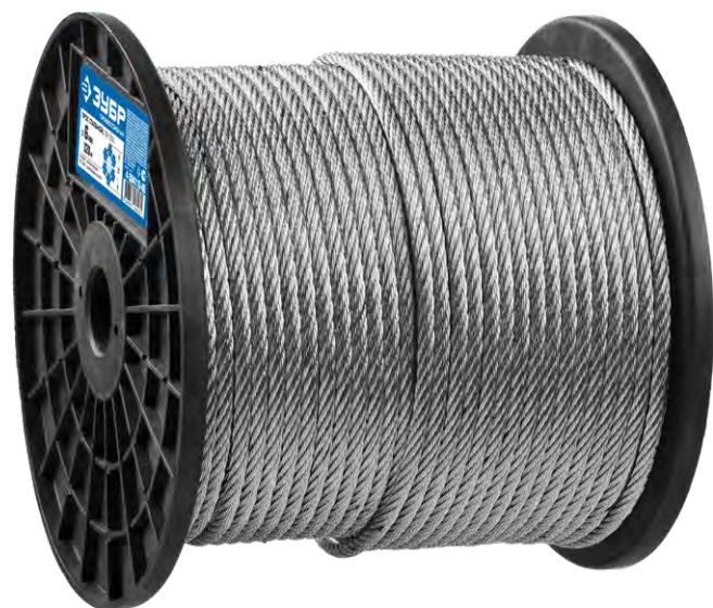
DIN 3055 – структура 6 x 7 (6 прядей, обвитых вокруг сердечника, по 7 проволок в каждой пряди)
