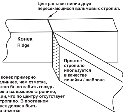
Рис. 10 Нахождение точек пересечения вальмовых стропил с коньком
