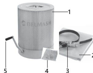
Рисунок 1. BELMASH C370A 1 – фильтр-картридж, 2 – стружкосборник, 3 – зажим, 4 – комплект крепежа, 5 – рукоятка
