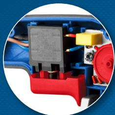
Выключатель с **большим запасом по току:** выдерживает перегрузки и частые включения
