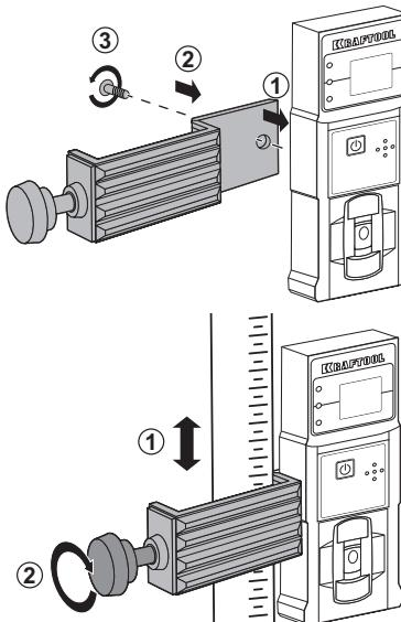
Детектор можно использовать различными способами. При проведении измерений Вы можете держать прибор в руках или использовать зажим для крепления детектора к рейке или подобному объекту.
