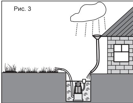
Опустите насос в воду на необходимую глубину или на дно емкости, если глубина не превышает максимально допустимой глубины погружения для данного насоса, держа его за шнур. При этом придерживайте сетевой кабель и шланг, чтобы они не упали в воду.
