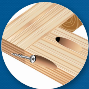
Соединение на косой саморез
