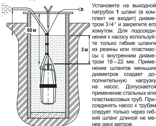
Установите на выходной патрубок 1 шланг (в комплект не входит) диаметром 3/4" и закрепите его хомутом. Для подсоединения к насосу используйте только гибкие шланги из резины или пластмассы с внутренним диаметром 18–22 мм. Применение шлангов меньших диаметров создает дополнительную нагрузку на насос. Допускается применение стальных или пластмассовых труб. При соединять насос к трубам следует только через гибкий шланг длиной не менее двух метров.
