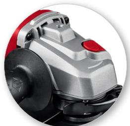
Корпус редуктора из алюминиевого сплава
