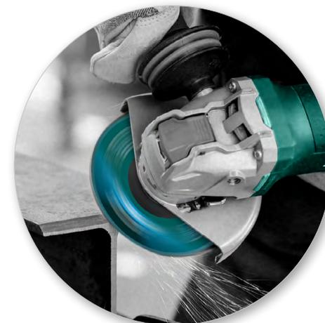
**Абразив оптимально подходит для шлифования сталей с высоким антикоррозийным эффектом, а также для вольфрамовых, титановых и никелевых сплавов**
