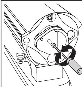
4. Регулировка рабочего давления
